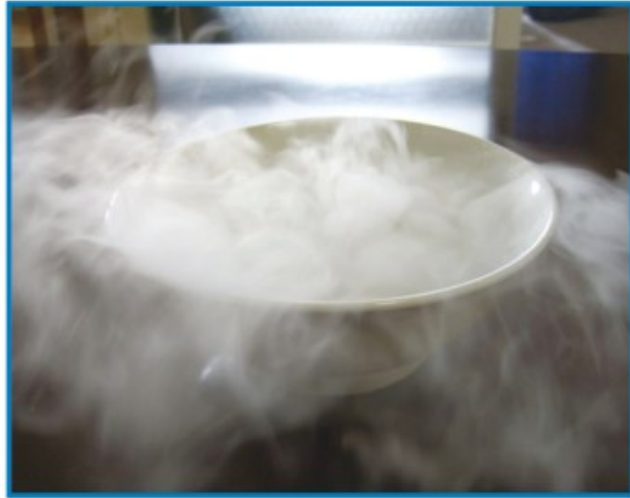
الثلج الجاف المصنوع من الكربون والأكسجين (CO2) يتسامى عند درجة حرارة الغرفة.
